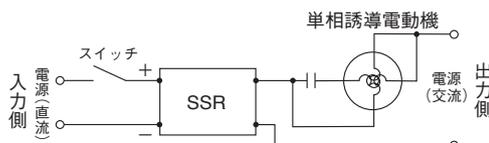
電動機は、動作初期において突入電流が流れますので、各々のサージ電流特性範囲内でご使用ください。
