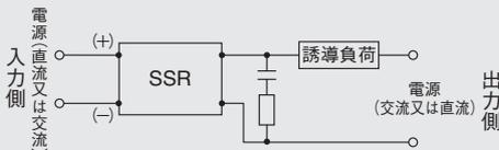
リアクタンス分が特に大きい誘導性負荷の場合は、電圧立上りが非常に速く（転流時臨界オフ電圧上昇率 $dv/dt$ が大きく）なって、誤動作するおそれがあります。
