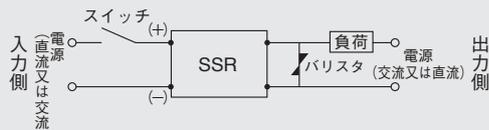
電源側のノイズ環境が悪く、SSRに大きなサージ電圧が印加されると、誤動作するおそれがあります。このような場合には、上図のようにバリスタを接続してください。使用するバリスタ電圧は、電源電圧が110Vの場合は200~300Vのものを、220Vの場合は350~450V程度のものを推奨します。
